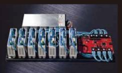
コントローラはシリンダ8軸DC モータ制御2軸※まで対応。各軸 独立で高速制御、CPUで動作、軸 による反応の遅れがないよう、設 計されています。
