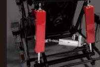
ACSIM2-S07Fにはシート部分に3本のシリ ンダを使用しています。横G縦Gで前後左右動 作し、リアのスライドで回転動作を表現。これ により、車両の挙動をフレームで再現、G表現 をシートで再現し、限りなく実車に近い操作感
